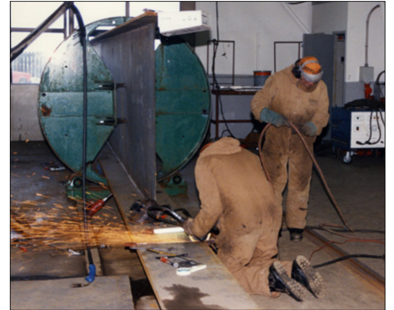
Vélsmiðja Vegagerðarinnar í Grafarvogi var vel búin til að smíða stálbita fyrir brúagerð.
